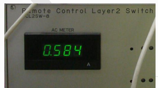
フロントパネルに搭載された電流計により消費電力のモニタが可能
