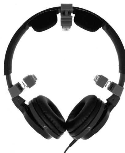
図3(b) 短時間設置、長時間脳波計測可能な脳波計測ヘッドセット
